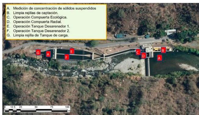
Fig. 1. Subprocesos del sistema de captación de agua.
