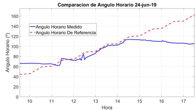
Fig. 14. Validación del sensor MPU6050 midiendo el ángulo horario.
