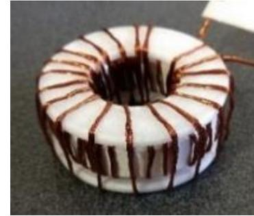
**Fig. 1. Inductor del filtro de salida.**
