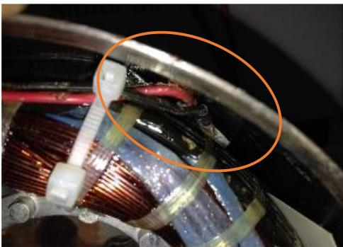
Fig. 7. Colocación física del sensor entre el núcleo del estator y la carcasa del motor.
