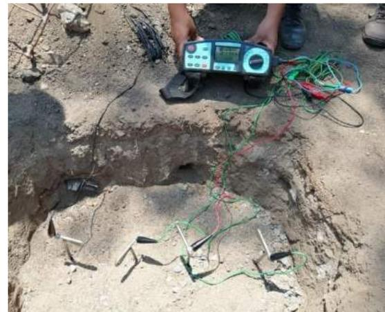
Fig. 5. Practica con el terrómetro.
