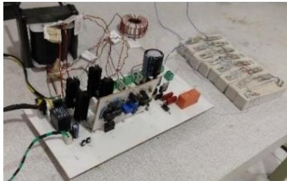
Fig. 5. Prototipo del convertidor elevador CD-CD *push-pull*.
