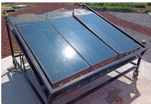
Fig. 2. SAH instalados en plataforma.
