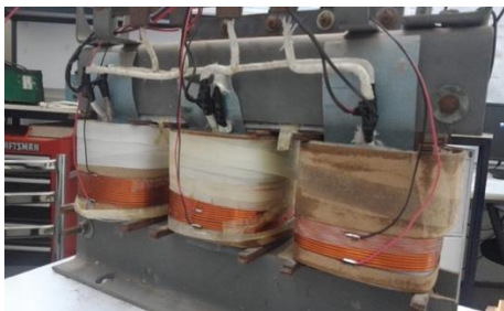
Fig. 9. Modificaciones realizadas en el devanado para la simulación de las fallas.
