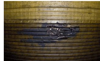
Fig. 5. Corto circuito entre espiras en la parte superior del devanado primario de un transformador.
