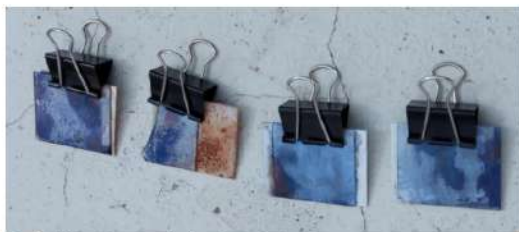
Fig. 2. Celdas solares orgánicas terminadas.
