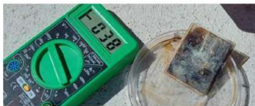
Fig. 3. Medición de la corriente y voltaje de la celda orgánica.
