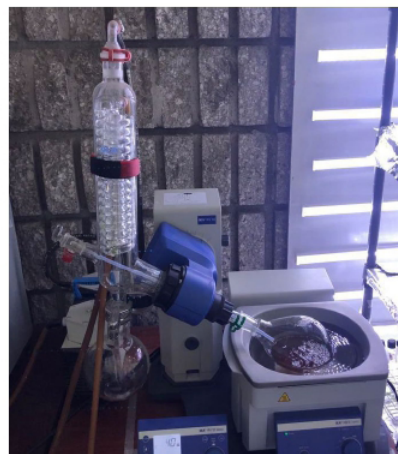
Fig. 2 Extracción de solvente con rotavapor. Elaborado por fuente propia.
