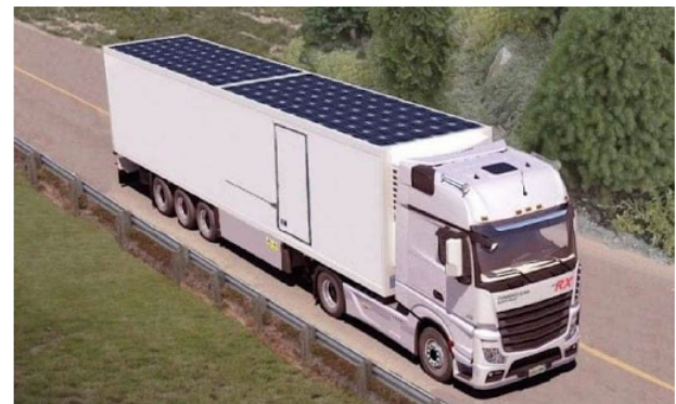
Fig. 7. Propuesta de instalación de módulos solares en cajas de refrigeración.
