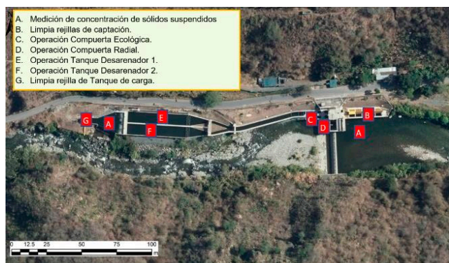
Fig. 1. Subprocesos del sistema de captación de agua.
