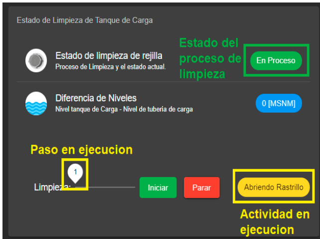
Fig. 7. Inicio del proceso de limpieza de la rejilla del tanque de carga.
