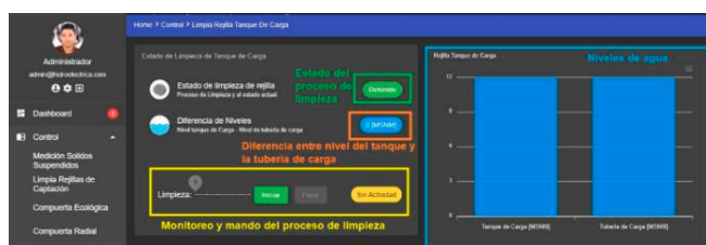
Fig. 6. Monitoreo del módulo de limpia rejilla del tanque de carga.
