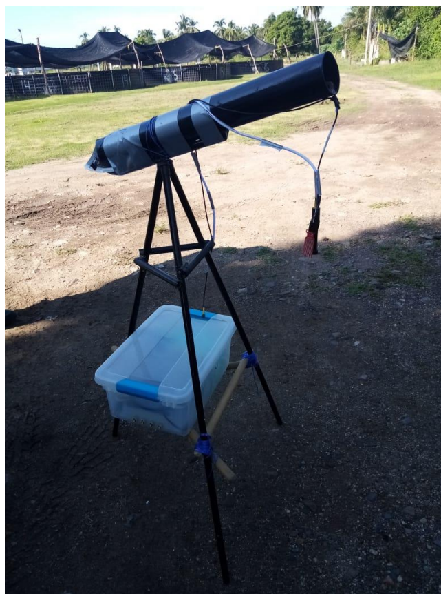
Fig. 8. Grúa para subir y bajar el sensor.
