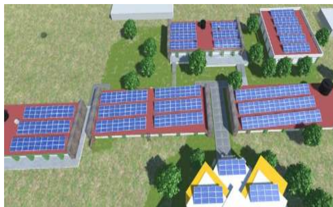
Fig. 2. Diseño de entorno virtual de instalación fotovoltaica 3D de 200kW.
