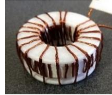
Fig. 1. Inductor del filtro de salida.
