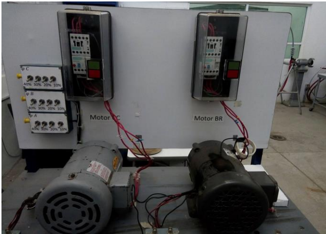
Fig. 2. Banco de pruebas de fallas de motores de inducción en corto circuito (CC) y barras rotas (BR) en el rotor.
