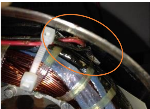
Fig. 7. Colocación física del sensor entre el núcleo del estator y la carcasa del motor.
