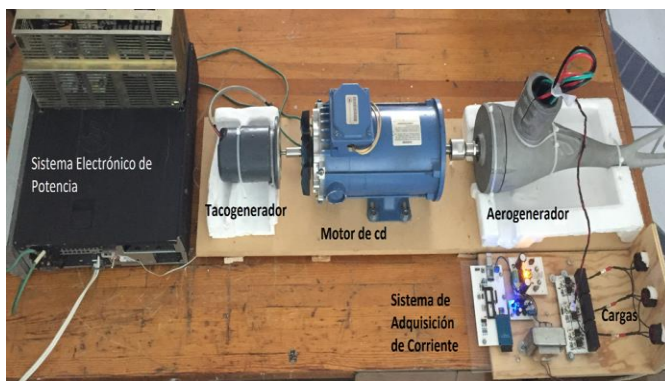
Fig. 4. Plataforma experimental para la detección de fallas eléctricas en estator de aerogeneradores.
