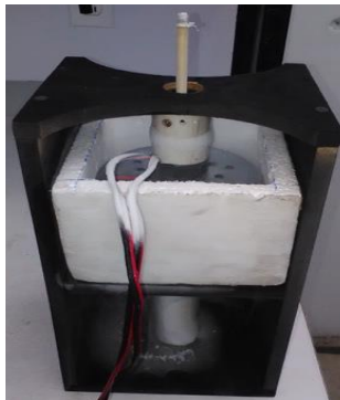
Fig. 7. Prototipo del generador lineal construido para la evaluación del modelado en elemento finito.
